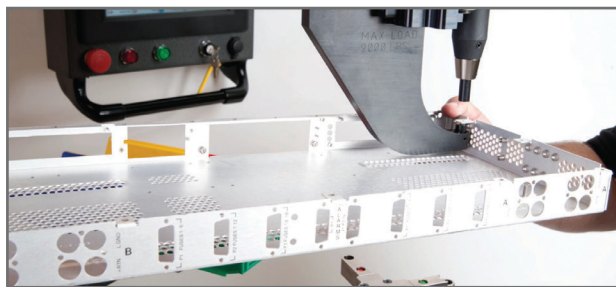
手动 J 型钩搭配 24”（610 毫米）喉深
