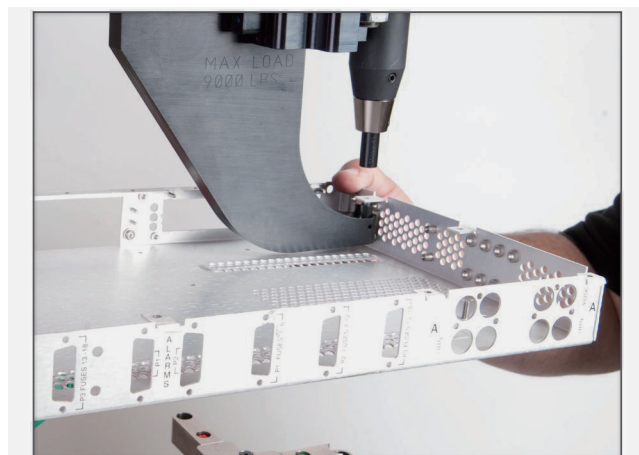
手动 J 型钩 用以加工小型折弯件
